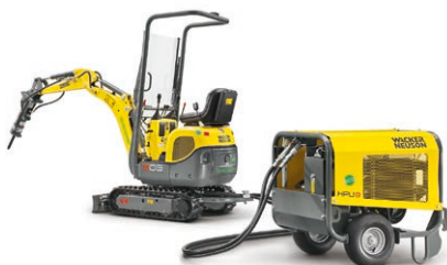
Bagger 803 dual power mit HPU
